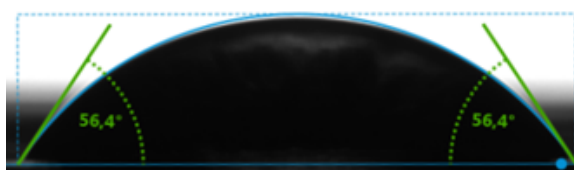
Рисунок 3. Краевой угол смачивания обработанного образца ПУ мембраны МТ-3 в течении 30 минут
